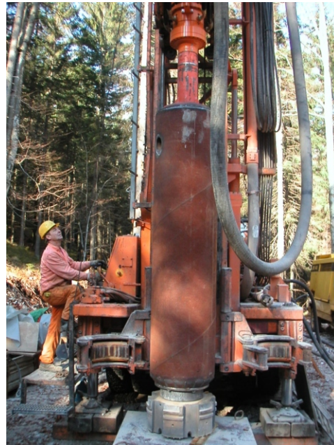
18" Hammer mit Button-Bit Ø 800 mm, Brunnenbohrung Grainau
